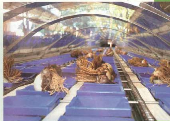
Fot. 9. Firma Terra Viva wprowadziła zmechanizowane kalibrowanie cebul, według ich masy (każda cebula jest ważona osobno w niebieskiej tacce)
